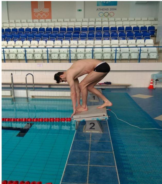
Рис. 1 – Тензометрическая платформа для исследования опорных реакций старта пловца
